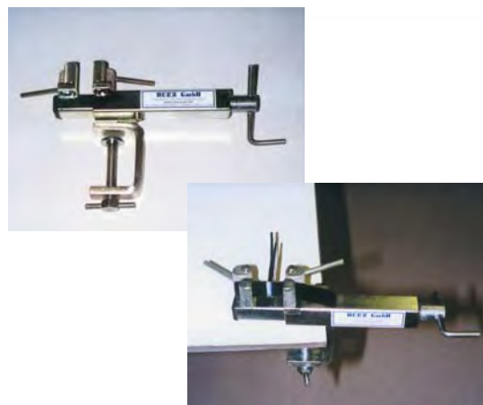
Ръчен уред за изпитване на опън – Хенди
